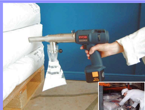
Horizontale Probenahme aus gestapelten Papier Säcken mit der 300mm Stechlanze Ref. S6PH3R
