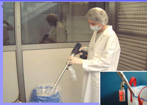
Senkrechte Probenahme aus Fässern o. Bigbags mit der 600mm Stechlanze Ref. S6PV6R
