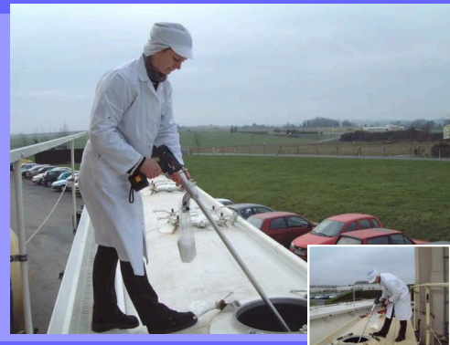
Senkrechte Probenahme aus einem Tankwagen mit der 1500mm Stechlanze Ref. S6PV15R
