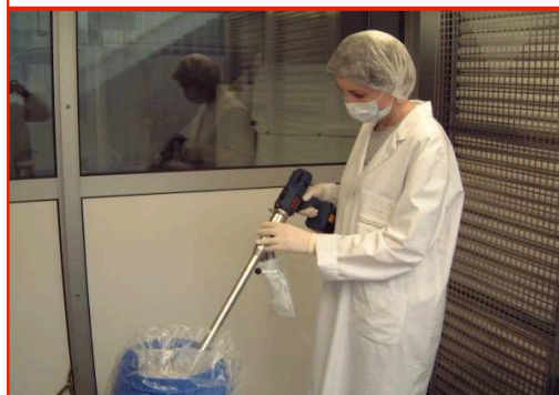
Prélèvement vertical en sachet ou flacon sur fûts ou big-bags avec une sonde longueur 600mm - Réf. S7PV6R
