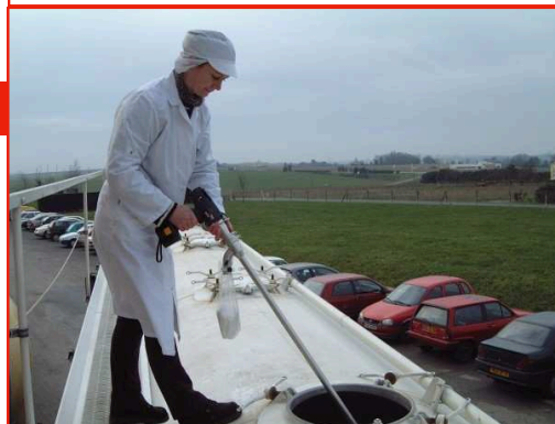
Prélèvement vertical en sachet sur camions-vcac et citernes avec une sonde longueur 1500mm - Réf. S7PV15R
